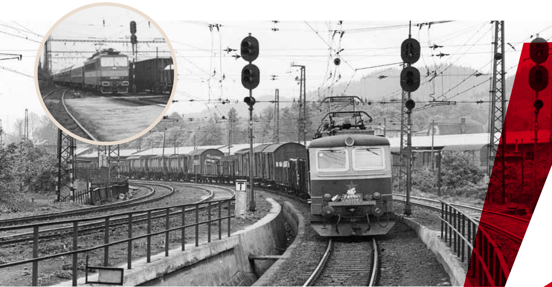
Škodoväcké lokomotivy první generace spojené s počátky elektrifikace začaly koncem osmdesátých let nahrazovat Peršingy s tyristorovou regulací.
