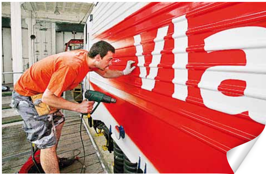
PRÁCE V DETAILU. Sedmičlenný realizační tým potřeboval k přeměně každé lokomotivy čtyři dny. U řady 380 bylo nalepeno zhruba 150 metrů čtvervečních fólie.
