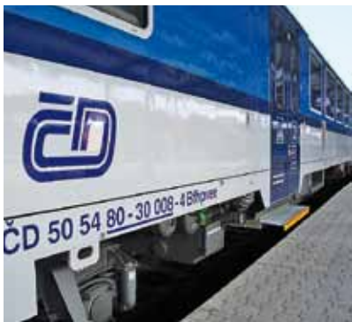
Výsuvný schůdek u dveří „zlobí“: nemá rád některá nástupiště.
