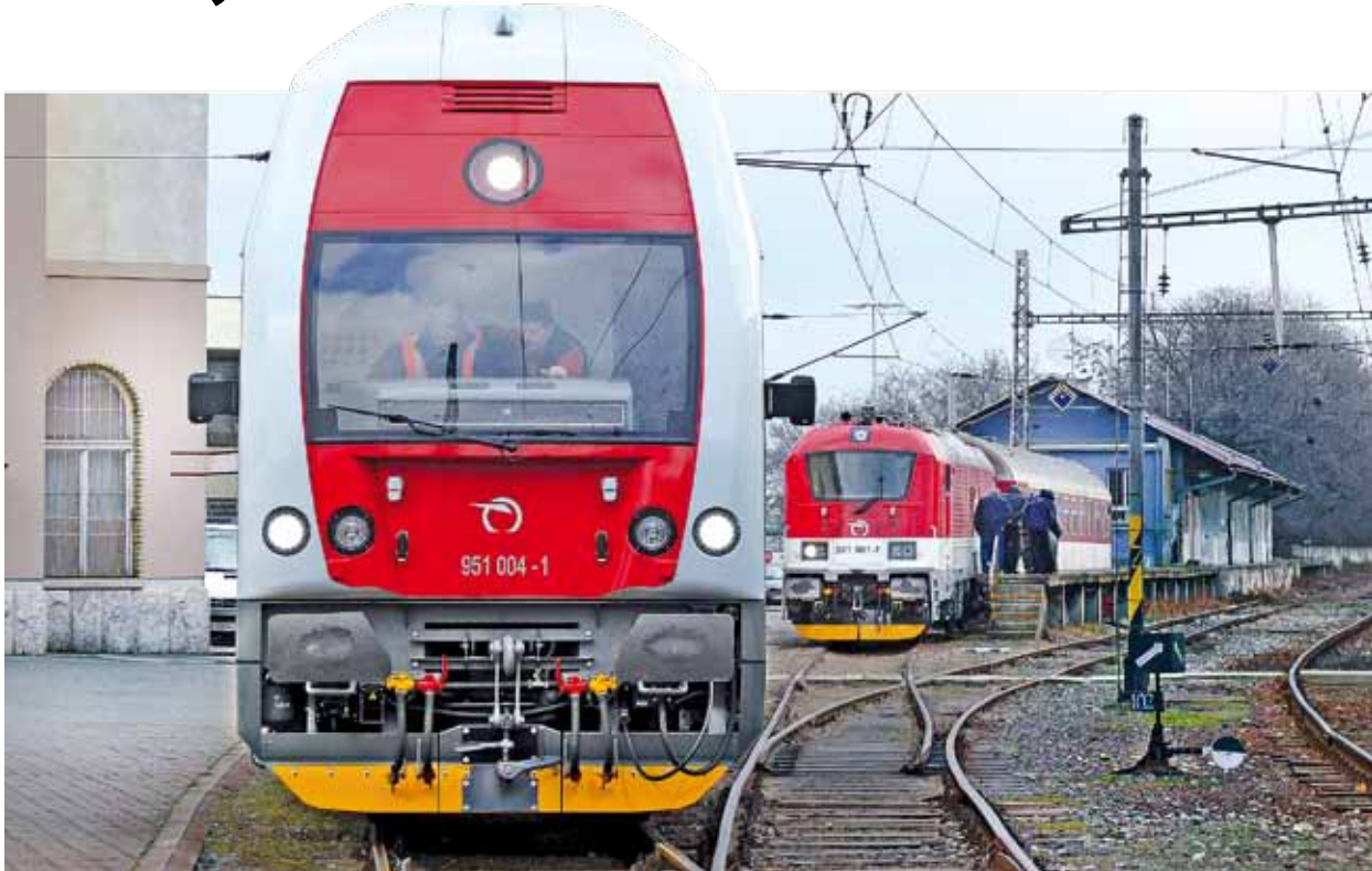
NOVINKA. Soupravu Push-Pull tvoří vždy jeden řidičův vůz, dva vložené vozy a upravená lokomotiva.
