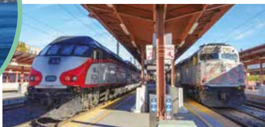
V železničním uzlu Jose Diridon Station se potkaly dvě generace lokomotiv příměstských vlaků – MP36PH-3C (vlevo) a F40PH-2CAT.
