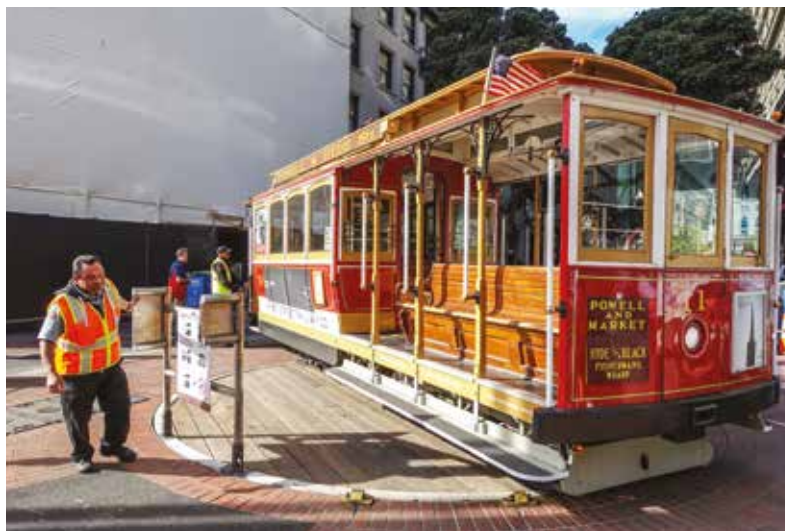
Sanfranciskou lanovou tramvaj je nutno na konečných otočit. Točna samotná je bez lanového pohonu, takže vozem manipuluje obsluha silou svých rukou.
