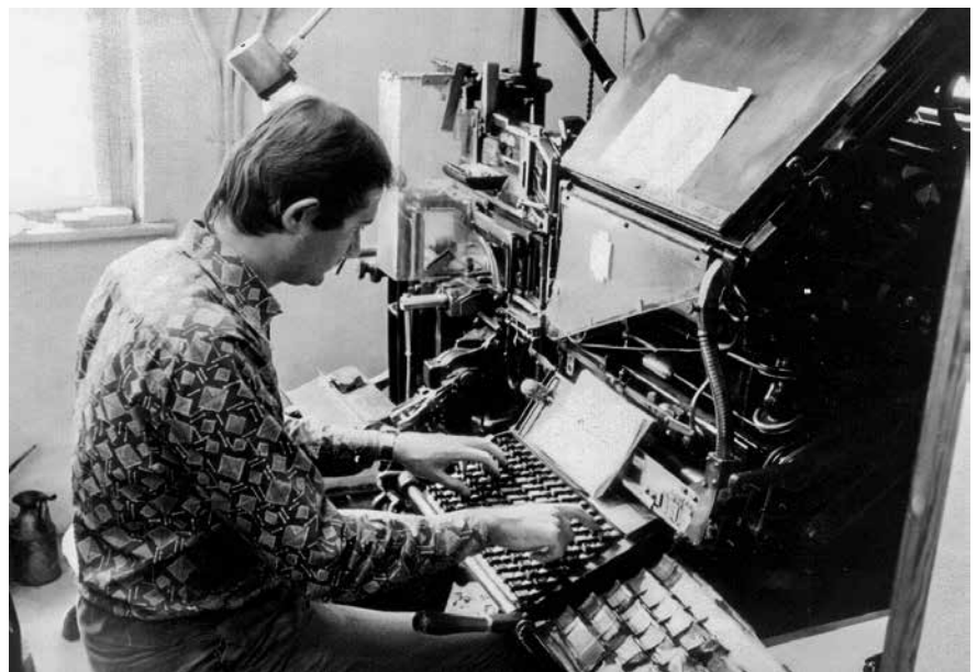
Sázecí stroj, s matricemi písma a rozmítacím systémem, odléval z horkého olova automaticky požadované řádky textů (snímek je z roku 1983). →
