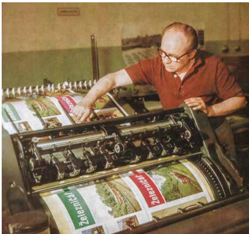
Jednobarevný jednoobrátkový stroj Heidelberg při tisku obálek Železničáře čísel 12 a 13 v roce 1980. Stroj pro tisk poslední, černé barvy připravuje tiskař pan Bouša. Snímek je z titulní strany Železničáře č. 20 z roku 1980, kde se psalo o výrobě tehdejšího časopisu vydávaného federálním ministerstvem dopravy v Nakladatelství dopravy a spojů.
